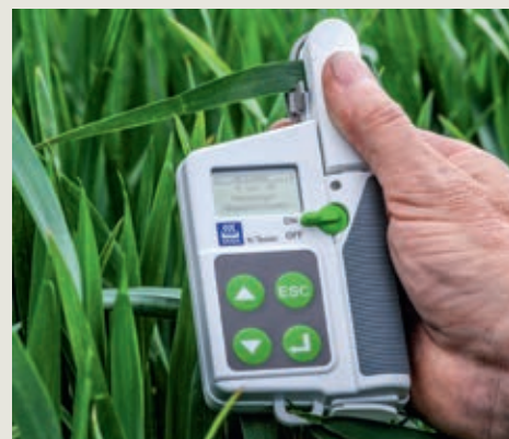
Rycina 16: Tester azotu firmy Yara N-Tester™ jest ręcznym narzędziem, które daje natychmiastową informację na temat rzeczywistych potrzeb azotowych roślin.
